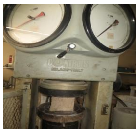
شکل ۳. آزمایش مقاومت فشاری یکی از نمونه‌های آزمایشگاهی در چک ملات‌شکن
